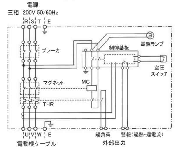
制御基板 (0.4kW・0.75kW)
