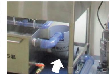
ホッパー式-間接排水で従来の可動式でメンテナンス容易がそのまま
